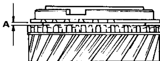
Bild 89 Spalt zwischen den Auflageflächen der Synchronringe und Gangräder wie gezeigt ausmessen. Der Abstand «a» sollte 1,1 mm betragen. Bei einem Spalt von annähernd 0,5 mm müssen die Synchronringe erneuert werden.
